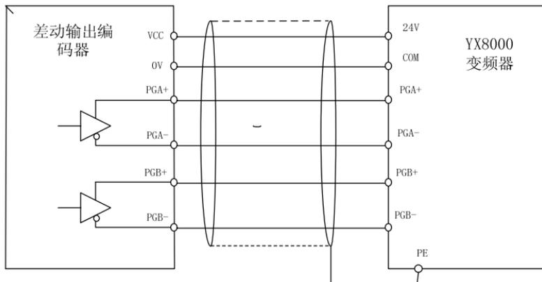
图 3-19 差动输出编码器接线图
