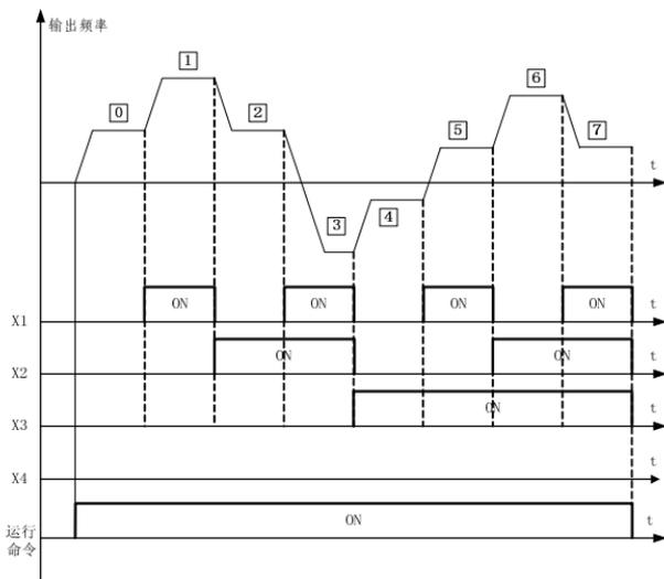
图6-09 多段速度运行逻辑图
