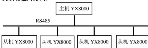
图 9-2 多机联动组网示意图
