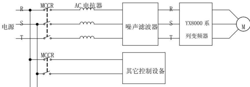
图 3-21 主回路电源侧连接图
