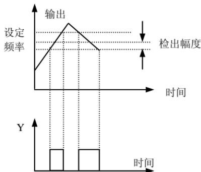
图6-24 频率到达检出幅值示意图
