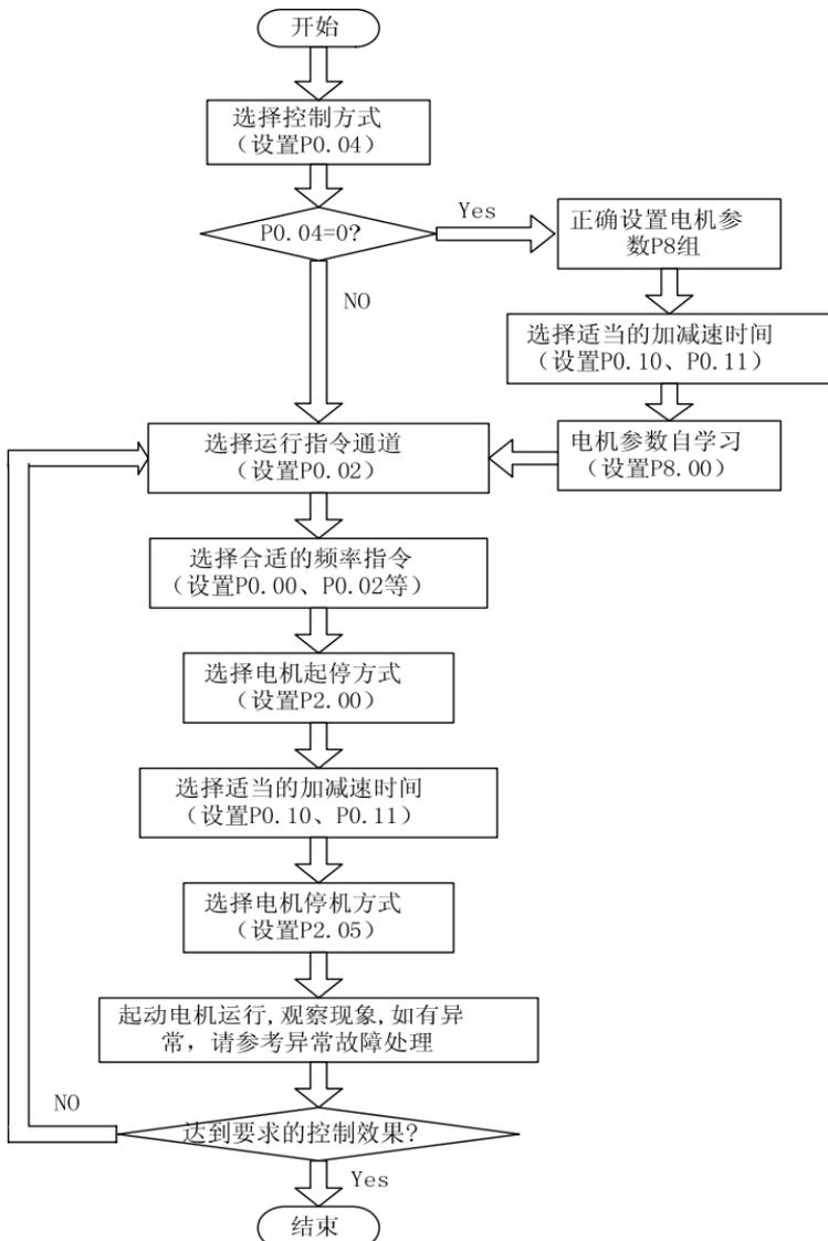
图 4-5 快速调试流程图
