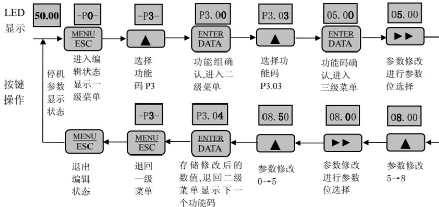
图 4-3 参数编辑操作示例
