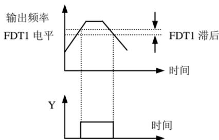
图 6-23 频率水平检测示意图
