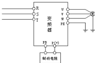
图 2-2 变频器与制动组件连线图
