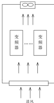
图 3-4 多台壁挂式变频器的安装 2
