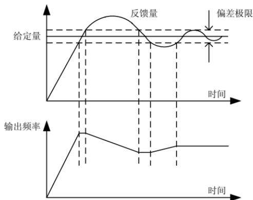
图6-17 偏差极限与输出频率的对应关系
