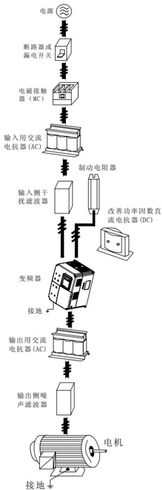
图 3-5 外围设备的连接图
