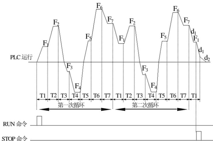
图 6-13 PLC 连续循环方式
