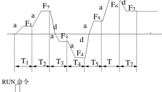
图 6-12 PLC 单循环后保持方式
