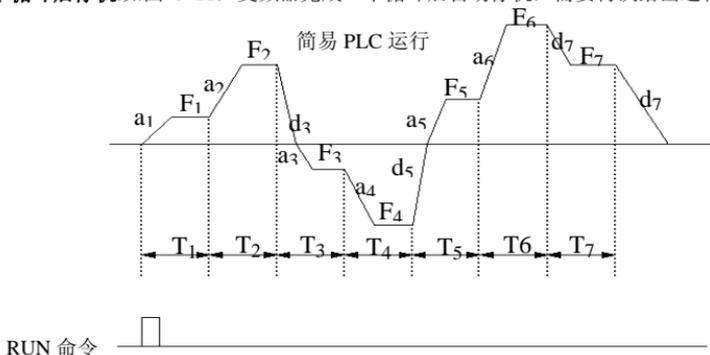
图 6-11 PLC 单循环后停机方式
