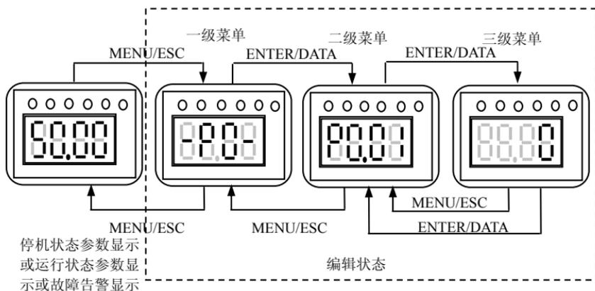
图 4—4 操作面板编程显示状态
