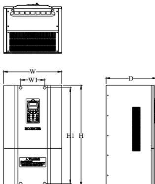
图 2-1 变频器的安装尺寸示意图
