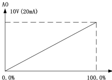
图6-25 给定量与模拟量输出的对应关系
