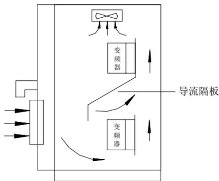
图 3-3 多台壁挂式变频器的安装 1
