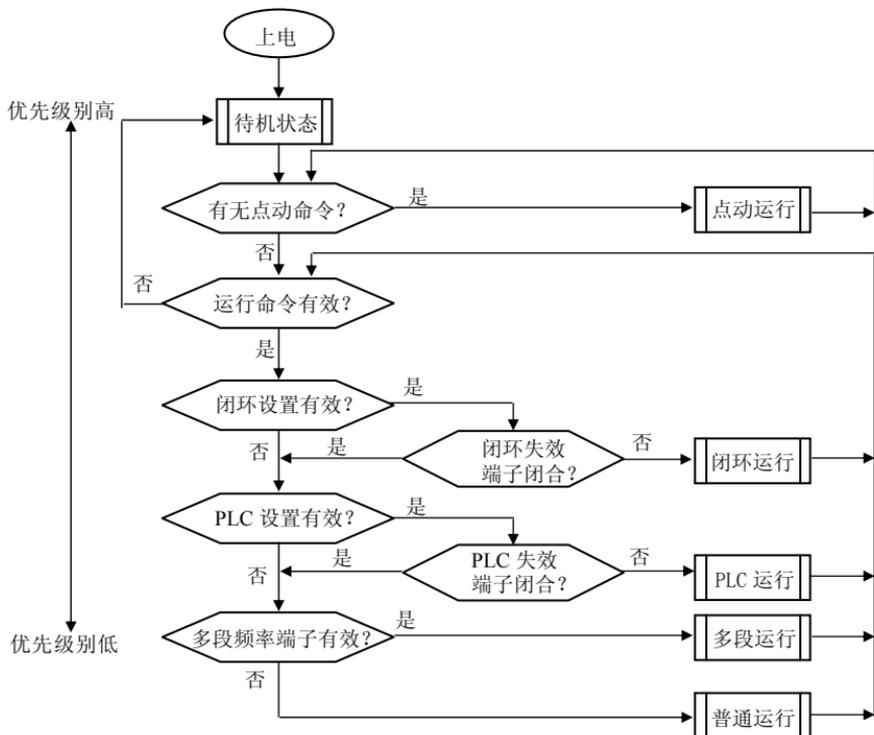
图 4-1 变频器运行状态的逻辑关系图
