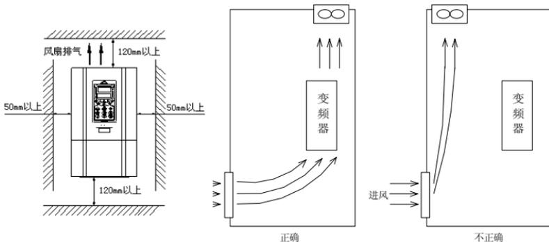
图 3-1 变频器安装间隔距离
