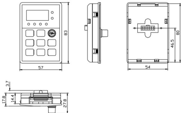
图 2-2 数码显示操作面板尺寸
