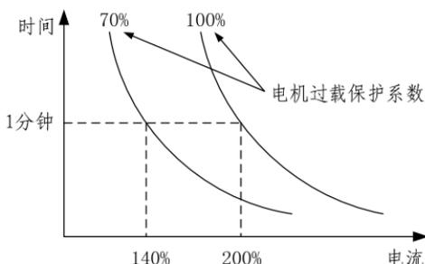
图6-27 电机过载保护系数设定
