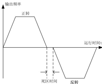
图6-8 正反转死区时间示意图
