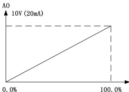
图6-22 给定量与模拟量输出的对应关系
