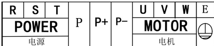
图 3-10 主回路接线端子图(4.0~5.5kW)
