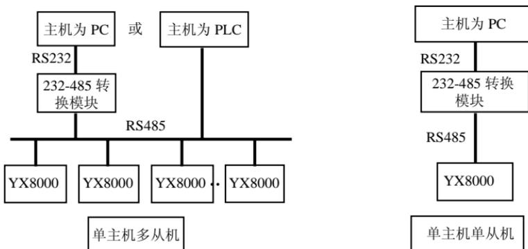
图 9-1 从机组网方式示意图
