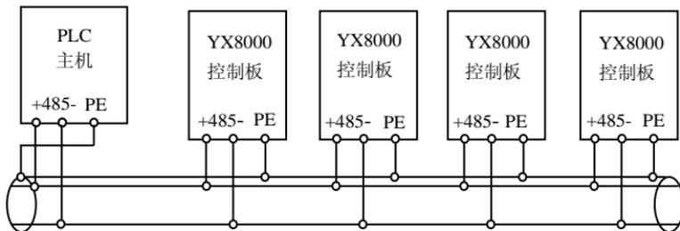
图 3-18 PLC 与变频器多机通信时的接线图(变频器、电机全部良好接地)
