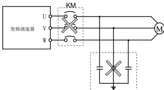
图 1-3 变频器输出端禁止使用电容器
