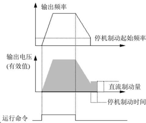
图 6 - 7 减速停车+直流制动示意图
