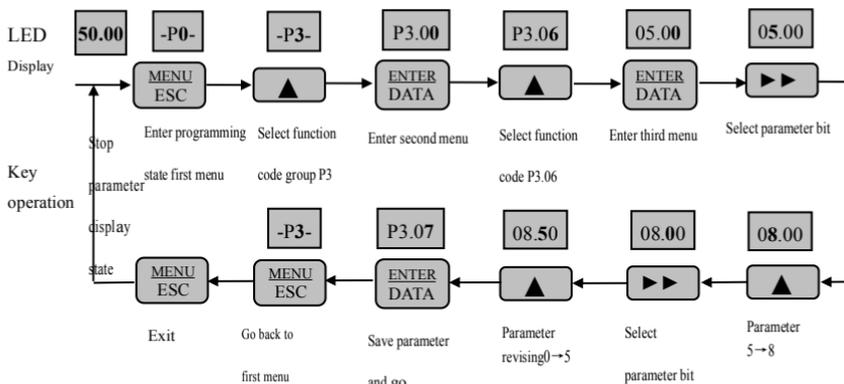
Fig. 4-8 Example of function code parameter setting
