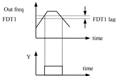
**图 6-27 freq level detection**
