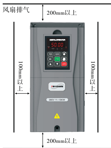
图 3-1 安装间隔距离示意图
